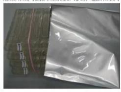
將鋁箔袋抽成 60%真空,然後熱壓封袋(Tray 盤缺角在左上角).貼出貨標籤,用透明膠帶包覆,然 後再貼 S/N 標籤.
